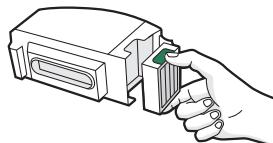
2 Nečistoty odstráňte poklepaním filtra o smetný kôš.
