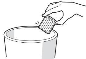
3 Znovu vložte filtr žebrovanými držadly směrem ven. Umístěte sběrný koš zpět do robota.
