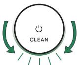
Amikor a robot érzékelni, hogy a portartályt ki kell üríteni, a fénygyűrű visszajelző pirosan világít a hátsó rész felé irányuló animált mozgással.
