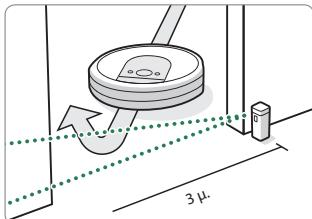
**Σημείωση:** Το πλάτος του εμποδίου γίνεται μεγαλύτερο καθώς απομακρύνεται από τη συσκευή (ανατρέξτε στην εικόνα).
