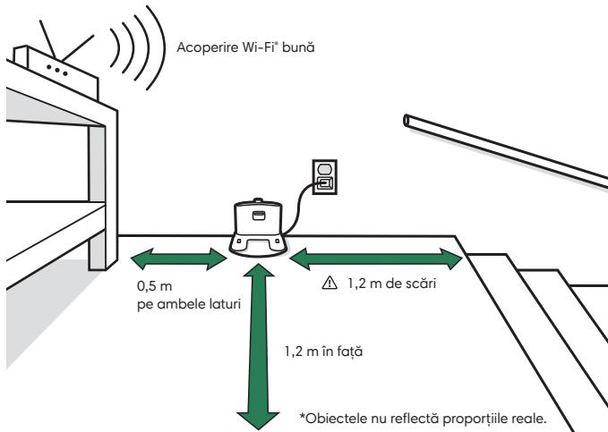
**AVERTISMENT:** Pentru a preveni riscul căderii robotului pe scări, asigurați-vă că stația de încărcare este amplasată la o distanță de cel puțin 1,2 metri de scări.
